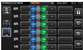
Mistahes hüdraulilist funktsiooni, kaasa arvatud esi- ja tagajaoatureid, esimest ja tagumist haakeseadist ja esilaadurit, saab juhtida mistahes juhtseadmega.
