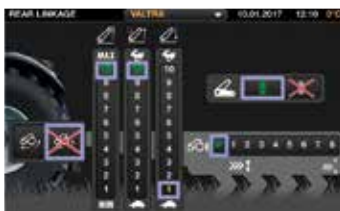
9-tolline puuetundlik ekraan, suured juhtseadmed, seaded ja funktsioonid on kergesti mõistetavad.
