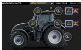
9-tollise puuetundliku ekraaniga on lihtne töötulesid konfigureerida. Juhtkonsoolis on ka toitenupud töötlede ja märgutule kasutamiseks.
