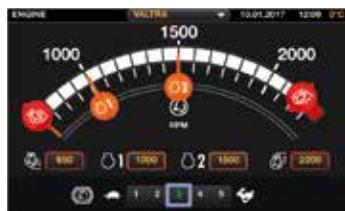
Seadistused on loogilised ja sõrmeliigutustega kergesti konfigureeritavad. Kõik sätted salvestatakse automaatselt mälusse.
