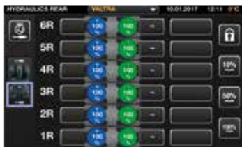
Mistahes hüdrauliilist funktsiooni, kaasa arvatud esi- ja tagajaotureid, esimest ja tagumist haakeseadist ja esilaadurit, saab juhtida mistahes juhtseadmega.
